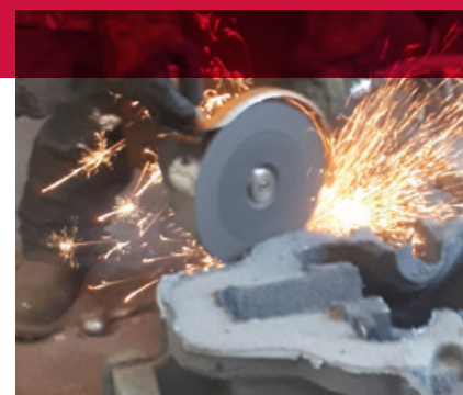
Limpieza de una pieza fundida con un disco combo.
