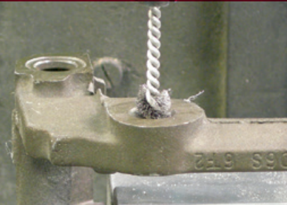
Eliminación de recubrimiento de zinc en barrenos en un soporte de freno.
