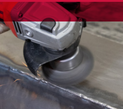
Copa de alambre trenzado removiendo rastros de decoloración térmica.
