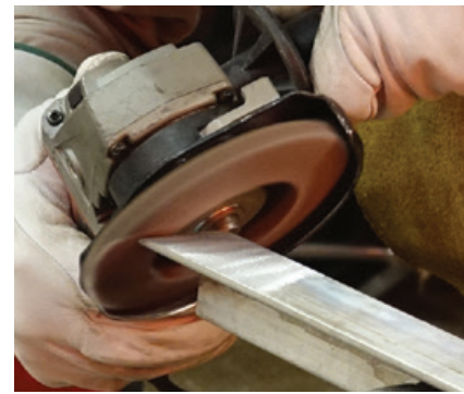
Biselado de una pieza de aluminio, preparándose antes de soldar.
