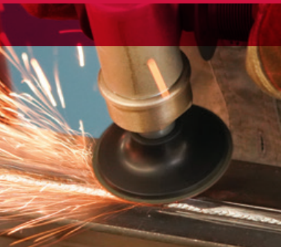
Disco para desvanecer cordones de soldadura.
