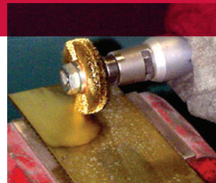
Creación de un acabado antiguo en una lámina de latón.
